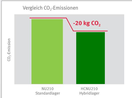
Vergleich der CO<sub>2</sub>-Emission eines Standardlagers und eines Hybridlagers im Antrieb eines Hochgeschwindigkeitszuges über eine Betriebsdauer von einem Jahr (ca. 600 000 km/a)
