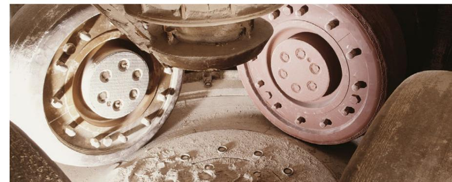
Mahlwalzen einer Vertikalmühle (Zementverarbeitung)
