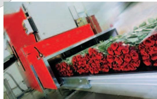
Langstieliges auf langen Wegen: INA-Gehäuseeinheiten gleichen Fluchtungsfehler in Transportbändern gut aus
