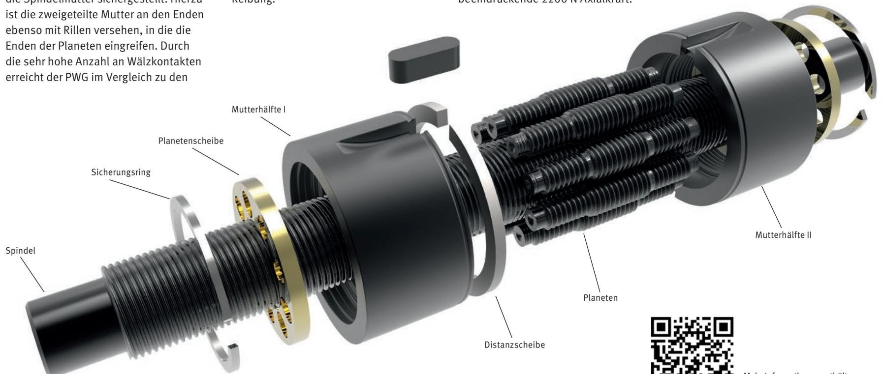
Aufbau des Planetenwälgewindetriebs PWG: Spindel und Planeten sind spanlos hergestellt
