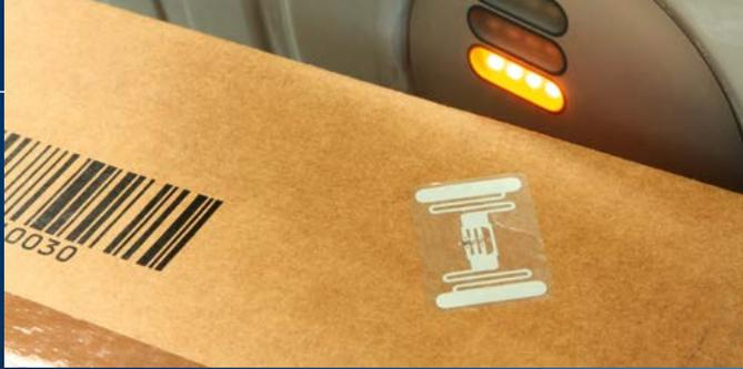
Vom Umschlaghafen bis zum Lieferwagen Ihres Paketboten: Mittels RFID (Identifizierung mittels elektromagnetischer Wellen) lassen sich Pakete lokalisieren – auch ein Teilbereich im Internet der Dinge
