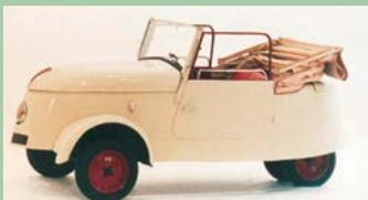
30 km/h Spitze, 80 km Reichweite: Der an der Steckdose aufladbare Peugeot VLV sollte den Benzinrationierungen der deutschen Besitzer ein Schnippen schlagen.
