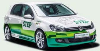
Konzeptfahrzeug im Golf-Gewand. Mit Radnabenantrieb und Zweigang-Lastschaltgetriebe. Die variable Übersetzung bringt 6% Verbrauchsvorteil
