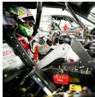
Typisch für DTM-Autos wie den Audi RS 5 DTM ist das vom Reglement vorgeschriebene Einheitsmono-coque aus Kohlefaser, in dem der Fahrer sitzt
