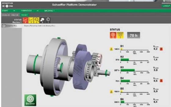
„Antriebsstrang 4.0“: eine typische Motor-Kupplung-Getriebe-Anordnung, bei der Messmodul und Monitoring-System (links) Daten zur vorausschauenden Instandhaltung an die Schaeffler-Cloud übermitteln
