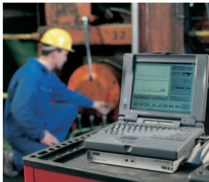
dienbare Schwingungsanalysator arbeitet nach dem bewährten HKD-Verfahren. Er diagnostiziert alle Schäden, die Geräusch verursachen, z. B. Anrisse, Pittings, Eindrückte oder Schmutz. Der an das tragbare Gerät angeschlossene Beschleunigungsaufnehmer mißt Schwingungen am Lager bis 20 kHz.
