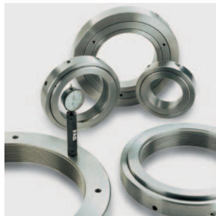
Durch das **Hydraulikverfahren** werden der Einbau und vor allem der Ausbau von Lagern ab ca. 160 mm Bohrung stark vereinfacht. Allerdings müssen Ölnuten und Zuführungskanäle sowie Anschlußgewinde für Druckerzeuger vorgesehen sein. Ausführliche Angaben siehe FAG-Publ.-Nr. WL 80 102 "Hydraulikverfahren zum Ein- und Ausbau von Wälzlagern".
