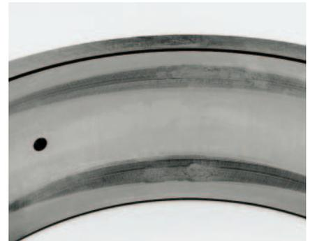
**Schlupfschaden auf der Tonnenrolle eines Pendelrollenlagers; Einbau bei einer Saugwalze; Ursache: zu geringe Belastung und ungeeignetes Schmierfett**
