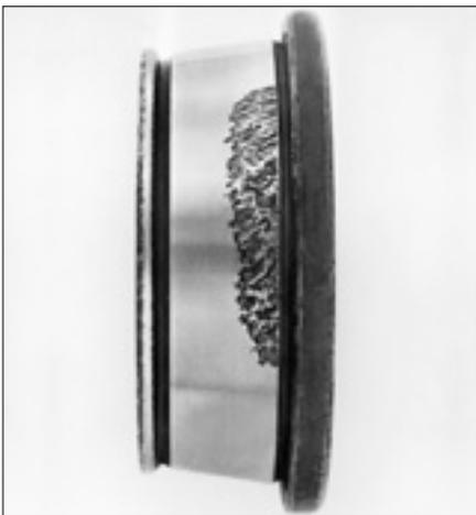
40: Verkippte Laufspur auf einem Kegelrollenlager
