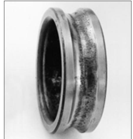
42: Fortgeschrittener Ermüdungsschaden am Rillenkugellager
