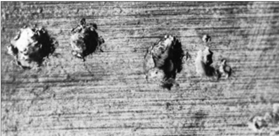
60: Die Riffelbildung in der Außenringlaufbahn eines Rillenkugellagers wurde durch stetigen Stromdurchgang erzeugt.
