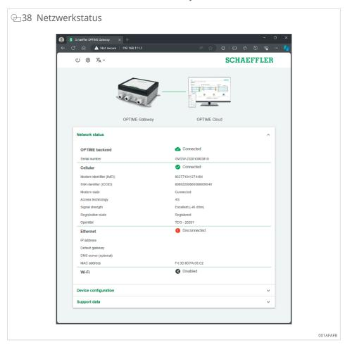
Oben auf der Seite zeigen die Linie zwischen den Bildern des OPTIME Gateway 2 und der OPTIME Cloud sowie die erste Zeile des Netzwerkstatus den Verbindungsstatus an:
