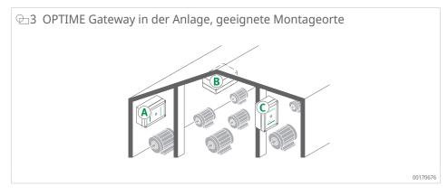
Bei der Auswahl des Montageorts ist zu beachten, dass Stahlbeton oder größere metallische Objekte die Abstrahlung in diesem Bereich abschatten können. Daraus folgt auch, dass ein OPTIME Gateway keinesfalls in einem metallischen Schaltschrank verbaut werden darf.
