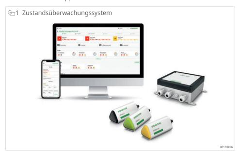
Die Sensoren und Schmierstoffgeber von Schaeffler OPTIME bilden automatisch ein Mesh-Netzwerk, das Daten direkt oder über andere Sensoren an das OPTIME Gateway überträgt. Im Netzwerk übermitteln die Sensoren Vibrations-Rohdaten sowie Kennwerte (KPI) über das OPTIME Gateway an die OPTIME Cloud. Dort erfolgt die Datenanalyse und die Analyseergebnisse werden an OPTIME Web App und OPTIME Mobile App gesendet. Alle Analysen
