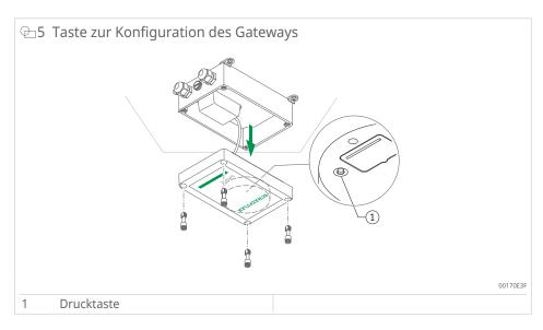
Durch Drücken der Drucktaste bringen Sie das Gateway in den Konfigurationsmodus ►40 | 7.
