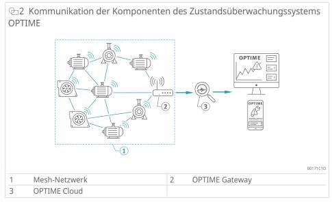
In der Standard-Version des OPTIME Gateways ist bereits eine SIM-Karte eingesetzt, die zur ausschließlichen Nutzung in Verbindung mit dem Zustandsüberwachungssystem OPTIME dient. Falls die angebotene Mobilfunkverbindung nicht genutzt werden soll, stehen mit Verwendung einer eigenen SIM-Karte, Verbindung per WLAN oder Verbindung per Netzwerkkabel weitere Optionen zur Anbindung an die OPTIME Cloud zur Verfügung.
