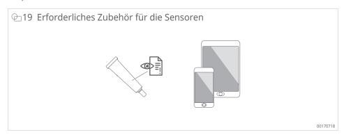
Als Kleber für die Befestigung der Montageplättchen für Sensoren eignet sich LOCTITE AA 330 mit Aktivator, LOCTITE SF 7388 oder ein Produkt mit vergleichbaren Eigenschaften.
