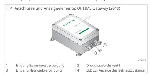
Das Druckausgleichsventil darf nicht entfernt werden.
