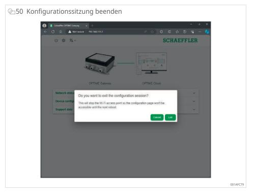
Wenn Sie die Konfigurationssitzung beenden, müssen Sie das OPTIME Gateway 2 neu starten, um es erneut in den Konfigurationsmodus zu versetzen und den WLAN-Zugangspunkt wieder zu aktivieren.
