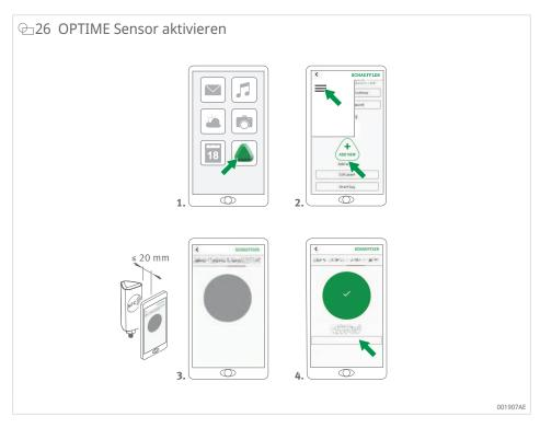
Die Aktivierung erfolgt in 2 Schritten. Im ersten Schritt wird der OPTIME Sensor aktiviert. Im zweiten Schritt werden die Netzwerkparameter übertragen. Zur finalen Bestätigung wird der Benutzer aufgefordert, die Einstellungen zu speichern. Je nach mobilem Endgerät wird jeder separate NFC-Kontakt quittiert, z. B. durch Vibration.
