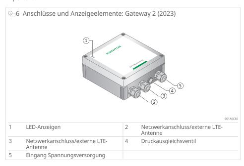
Das Druckausgleichsventil darf nicht entfernt werden.
