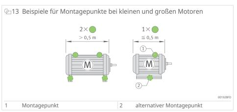
Bei Maschinen, die deutlich größer als 0,5 m sind, empfiehlt sich der Einsatz von mindestens 2 Sensoren, um mögliche Schäden gut erkennen zu können. Gleiches gilt, wenn 2 Maschinenteile durch eine Kupplung getrennt sind, da in diesem Fall die Schwingungen über die Kupplung nicht ausreichend gut übertragen werden.
