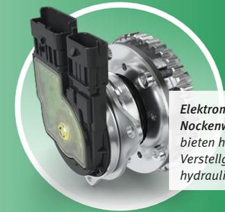
Elektromechanische Nockenwellenversteller bieten höhere Verstellgeschwindigkeiten als hydraulische Systeme
