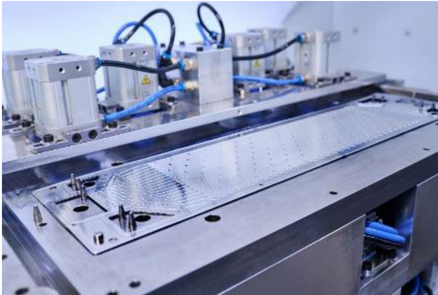
Metallische Bipolarplatten sind ein Schlüsselement der Brennstoffzellen-Stacks. (Bild: Schaeffler)
