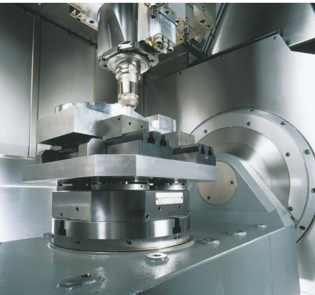
Präzisions-Rund-/Schwenktisch mit maximaler Leistungsfähigkeit durch INA-/FAG-Lagerlösungen
