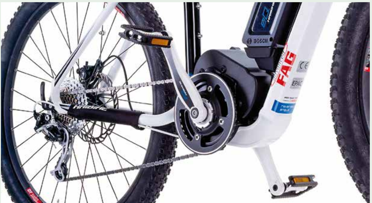
Sensoren-Tretlager von Schaeffler liefern die wichtigen Informationen für moderne E-Bike-Antriebe
