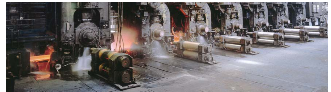
Bei der Stahlherstellung wirken gewaltige Kräfte und hohe Temperaturen auf die Walzanlagen und die darin verbauten Wälzlager. Vorausschauende Wartung kann die Verfügbarkeit deutlich steigern.
