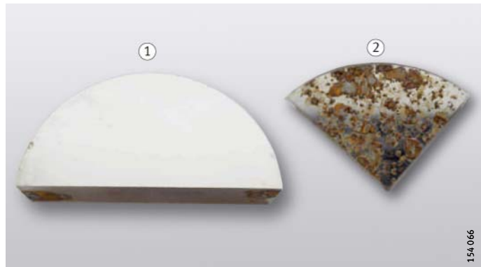
Bild 1 Korrosionsbeständigkeit, Vergleich nach 24 h Salzsprühetest
