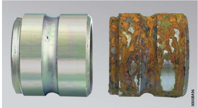
Bild 2 Beschichtetes und unbeschichtetes Teil nach 24 h im Salzsprühnebeltest
