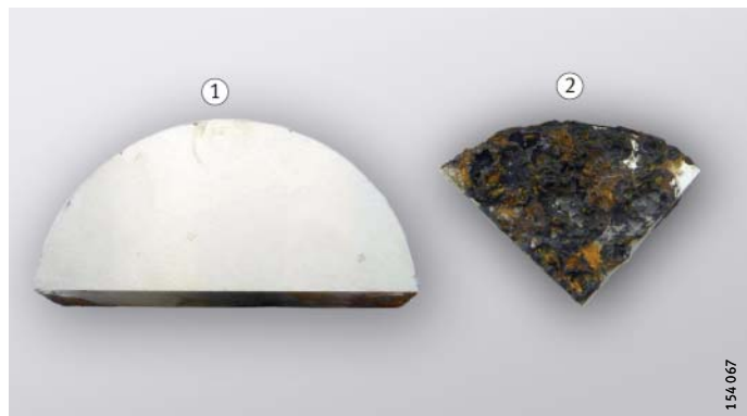
Bild 2 Korrosionsbeständigkeit, Vergleich nach 500 h Salzsprühetest
