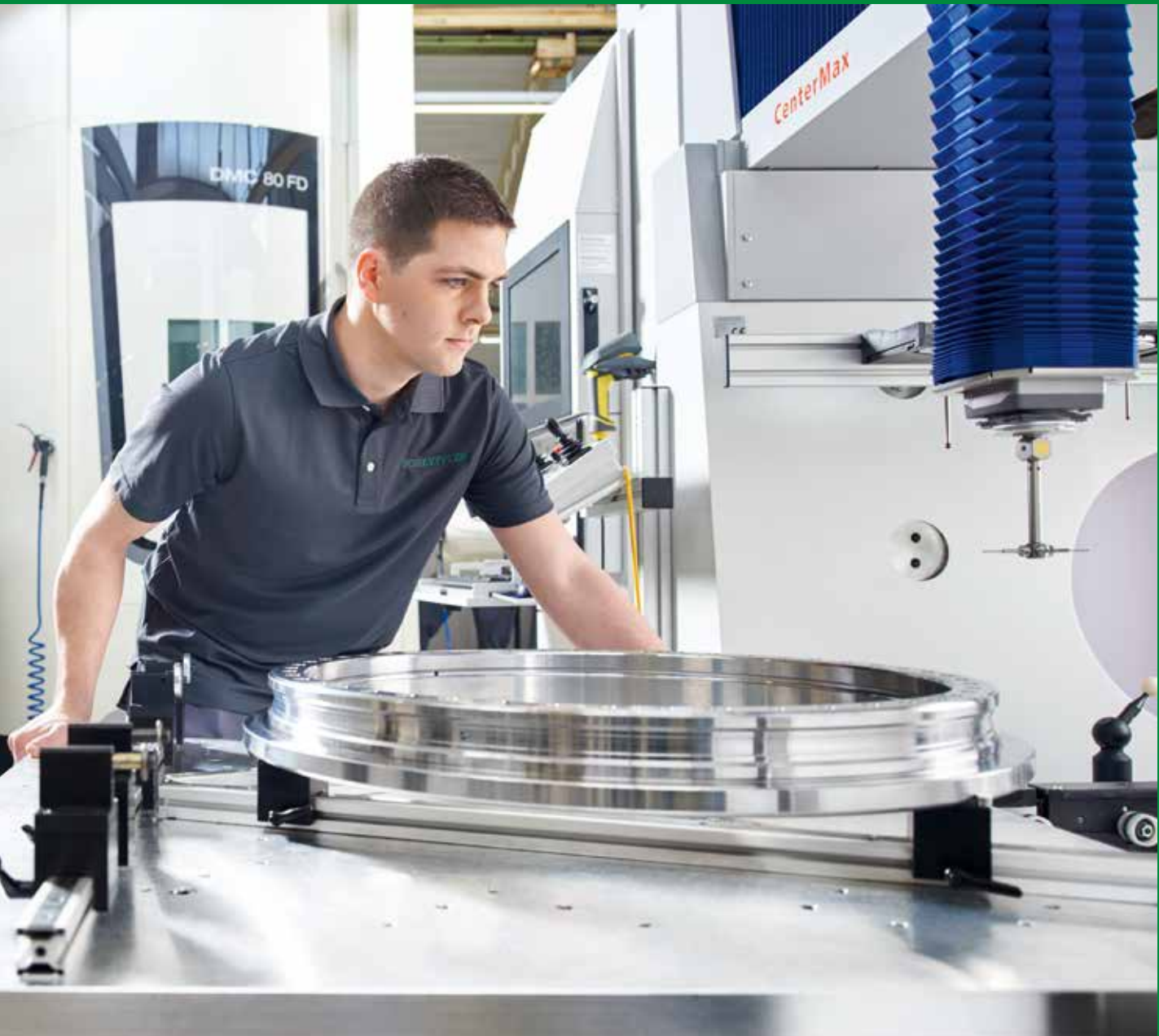
Oben Michael Sperber bei der Bedienung der 3D-Messmaschine, deren Messdaten zu Analyse Zwecken an die Werkzeugmaschine 4.0 zurückgeführt werden.
